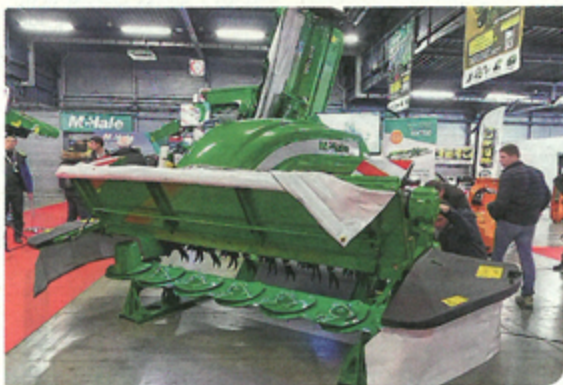
McHale exposait sa gamme de faucheuse portée arrière ou frontale, comme la F3100, dont le débattement vertical de 500 mm permet d'ajuster automatiquement le lamier à la structure du terrain.
